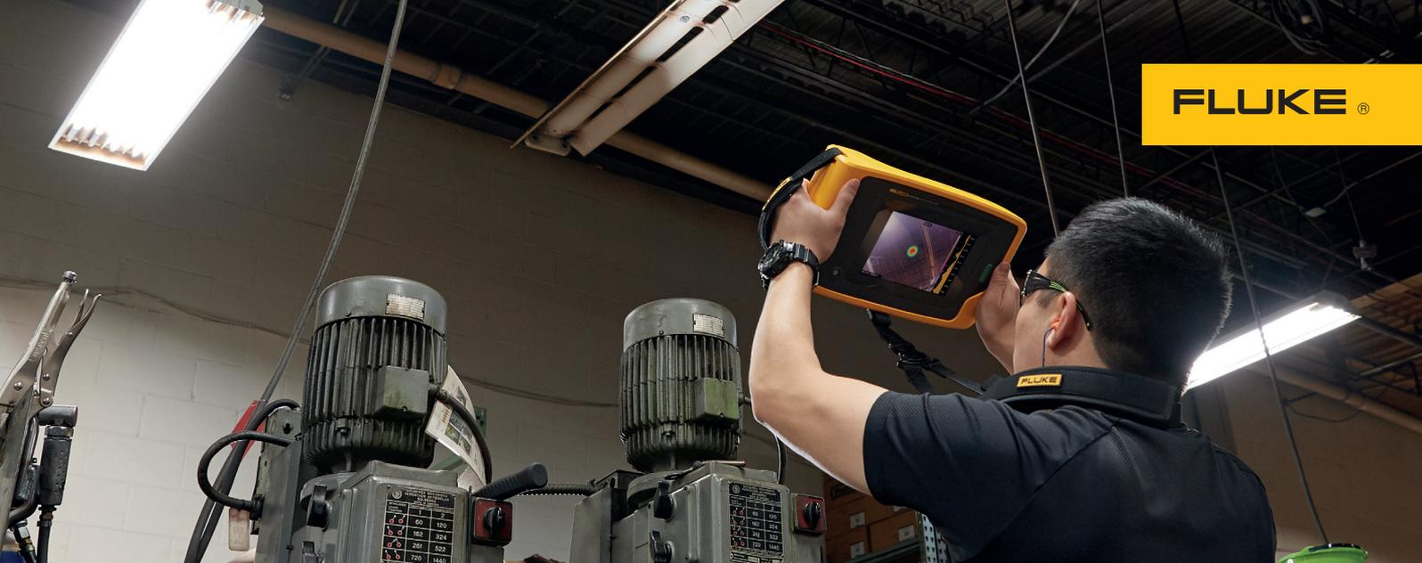
Inspektion von Druckluftleitungen mit der industriellen Schallkamera Fluke ii900
